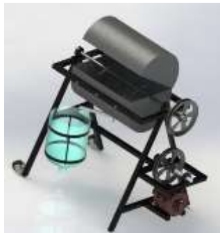
Figura 1. Diseño en programa CAD del lavador de tubérculos.
